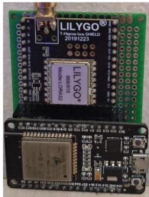
Gambar 4: Perangkat Transmitter
