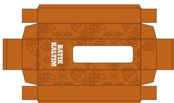
Gambar 15. Gambar kerja pola kemasan Alternatif Desain 6
