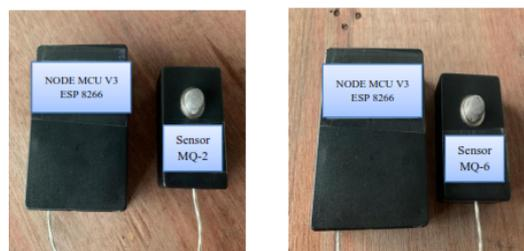
Gambar 8: Dua Prototype Sistem yang Sudah Dikemas dalam Box Module [Sumber: Tim Peneliti]
