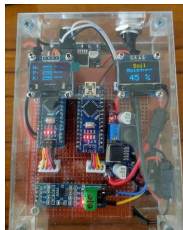
Gambar 3. Tampilan data Sensor NPK dan Kelembaban tanah pada LCD oled
