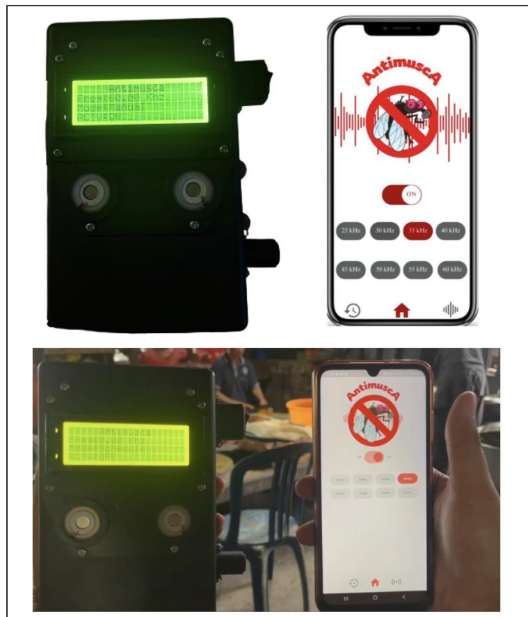
Gambar 3. Prototipe dan Antarmuka Aplikasi IoT Sistem Pengusir Lalat Otomatis Berbasis Ultrasonik
