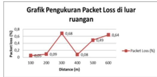
Gambar 11 Grafik pengukuran packet loss di luar ruangan
