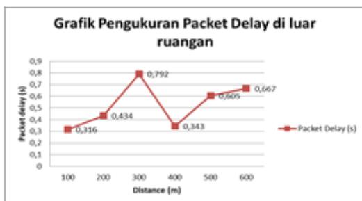
Gambar 10 Grafik pengukuran packet delay di luar ruangan
