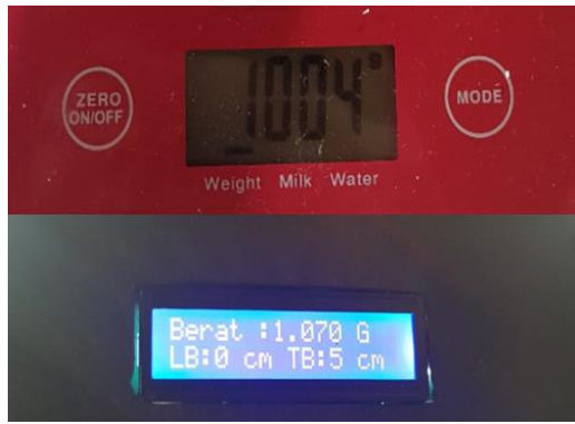
Gambar 9. Pengujian sensor load cell
