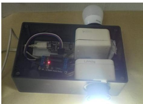
Gambar 11 Pengujian on/off lampu secara jarak jauh
