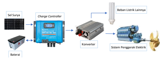
Gambar 3. Skematik sistem PLTS pada kapal laut
