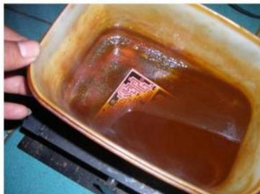
Gambar 12 Proses Pelarutan PCB
