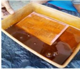
Gambar 10. Proses pelarutan menggunakan feriklorida
